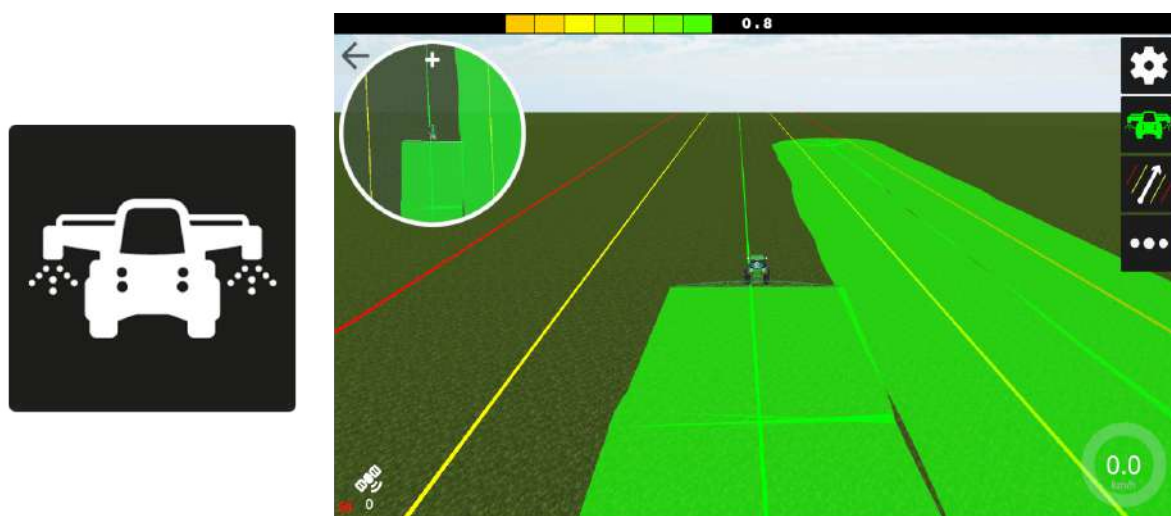
Figura 9: Rastreamento da pulverização em tempo real.
